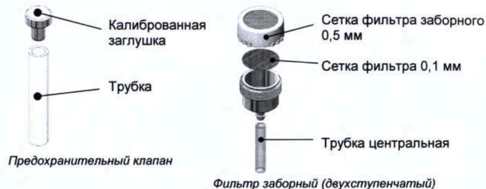
Рис.23 Предохранительный клапан и Фильтр заборный (двухступенчатый)
